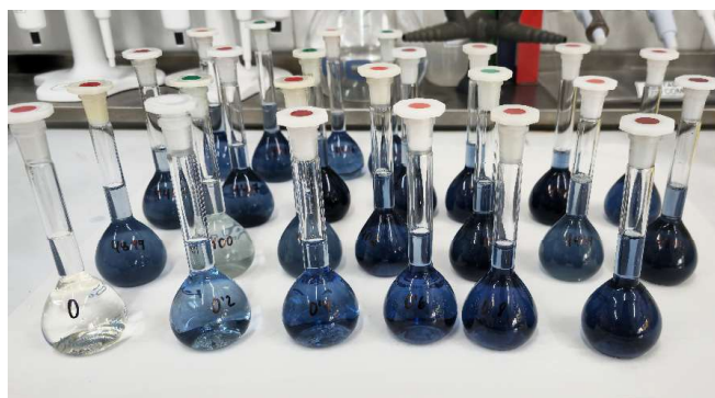
Cuantificación del fósforo en suelos de vid por el método colorimétrico Olsen
